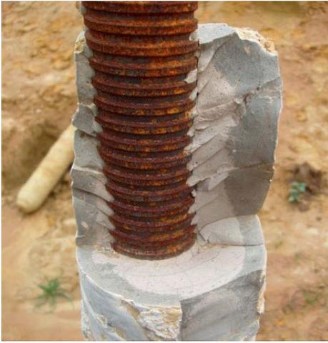
**Bild 5** Zementsteinüberdeckung eines selbstbohrenden Tragglieds infolge einer nicht zentrischen Lage im Bohrloch
