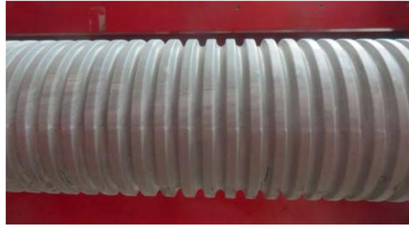
**Bild 1** Rissweitenprobe eines doppelt korrosionsgeschützten Vollstabtragglieds Ø 75 mm unter Spannung nach dem Ablösen des Kunststoffripprohres
