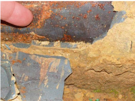
**Bild 6** Reduzierte Zementsteinüberdeckung eines selbstbohrenden Tragglieds im Bereich der Muffenverbindung nach dem Freilegen
