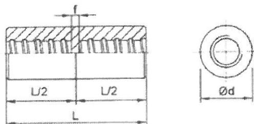
Geschraubte Muffenverbindungen und Verankerungen für Betonstabstahl
